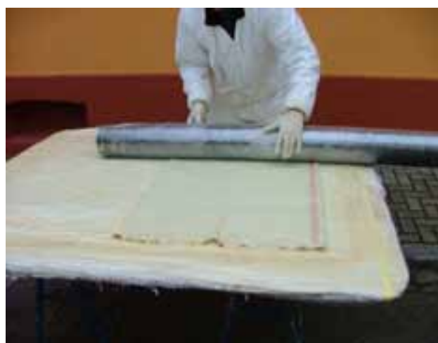
Fig. 20: Enrollar la malla de fibra de vidrio alrededor del packer
