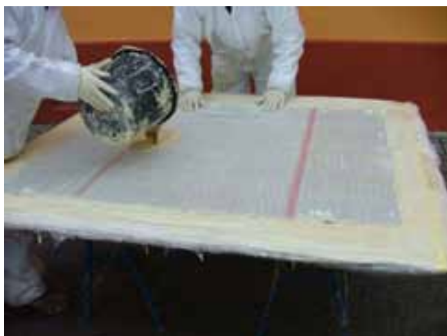
Fig. 17: Aplicar la resina sobre la parte posterior de la malla de fibra de vidrio
