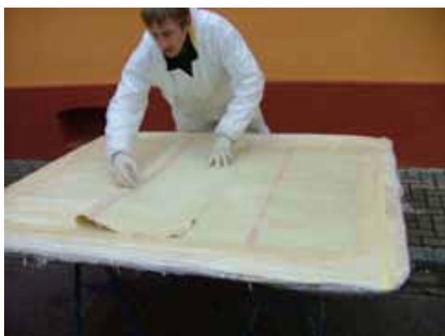
Fig. 19: Doblar los bordes hacia dentro
