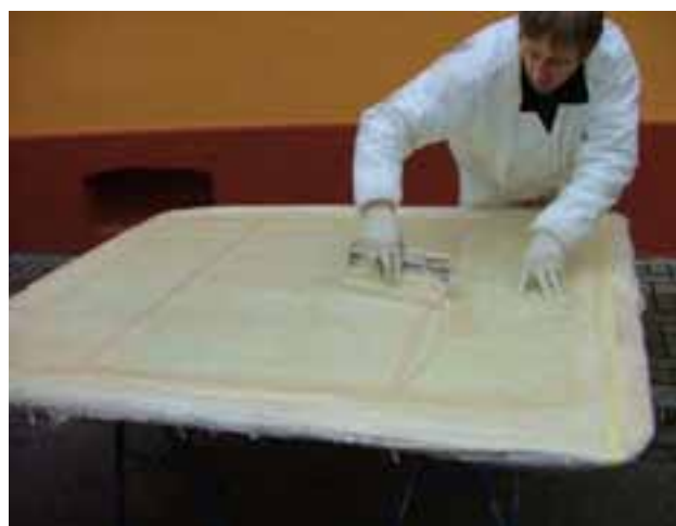
Fig. 18: Distribuir la resina sobre la parte posterior de la malla de fibra de vidrio
