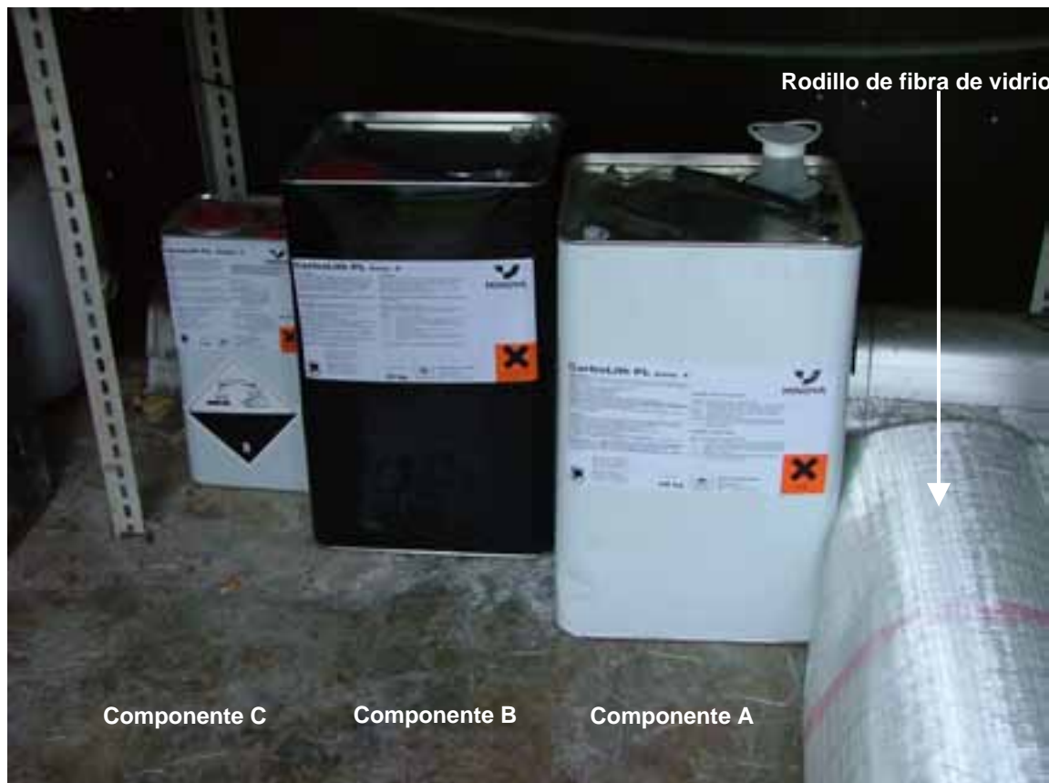
Fig. 6: Componentes para la elaboración de un manguito corto
