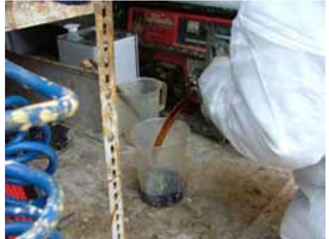
Fig. 8: Dosificación del componente B
