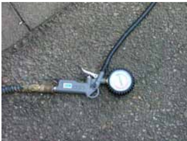
Fig. 23: Manómetro en el conducto de alimentación del packer
