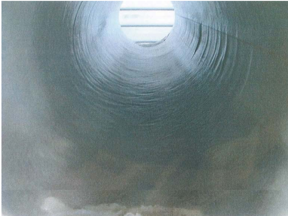
Fig. 4: Mitad superior del Thermoliner (L0120-1.2) después de 300.000 alteraciones de carga.
