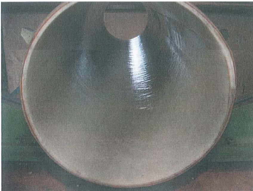
Fig. 1: Thermoliner (L0120-1) con un revestimiento interior de poliuretano de 0,35 mm antes del comienzo del ensayo
