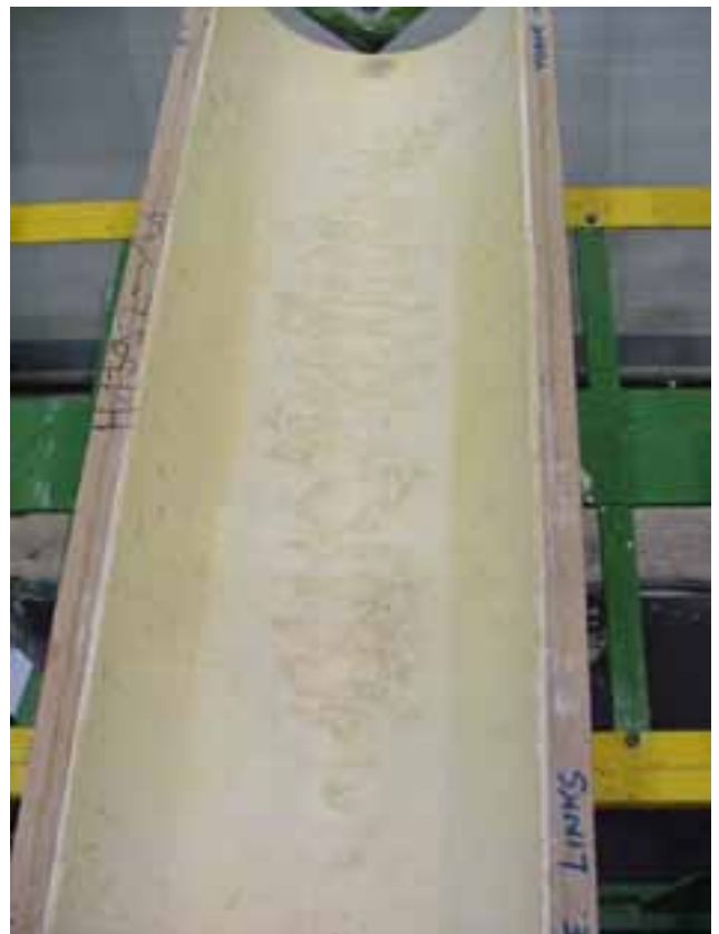
Fig. 13: Probeta H1392-1.1 después del ensayo de abrasión con 100.000 alteraciones de carga
