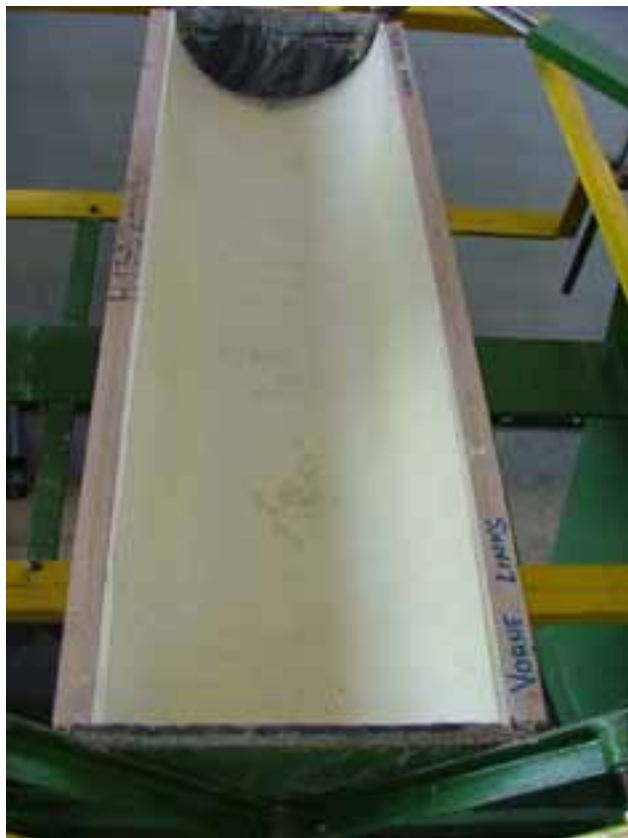
Fig. 12: Probeta H1392-1.1 después del ensayo de abrasión con 50.000 alteraciones de carga
